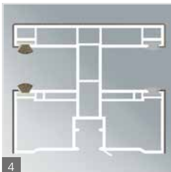
4 Einbaubeispiel für Maxi-Stäbe: wahlweise mit zwei Bürsten (links) oder zwei Maxi-Kedern (rechts).
